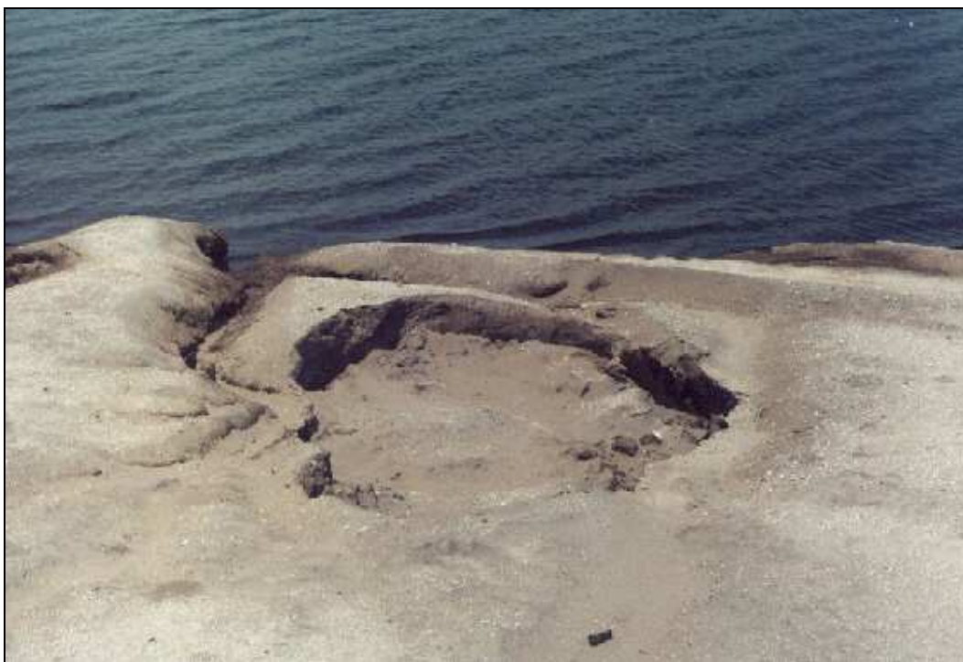
Fot. 5.3 Leż sufozyczny przy brzegu napełnianego zbiornika (fot. K. Polak)
